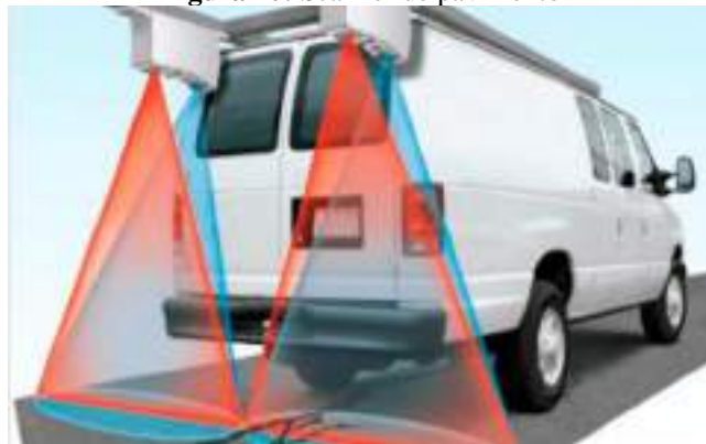
Figura 20: Scanner de pavimento
