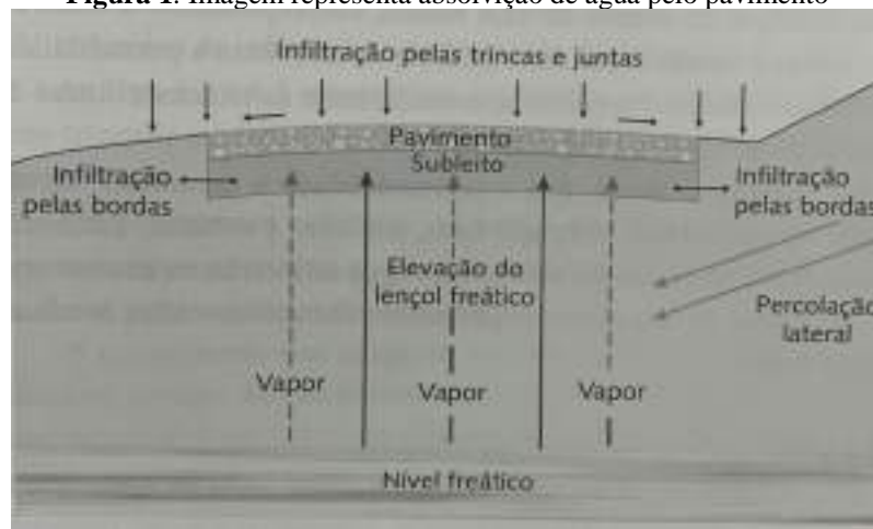
Figura 1: Imagem representa absorção de água pelo pavimento
