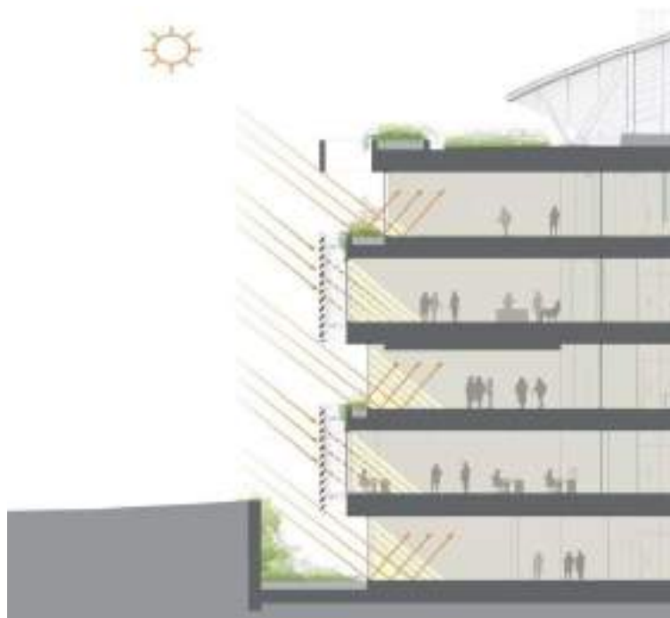
Figura 15: Esquema de brises atuando como redutores da entrada de luz solar.
