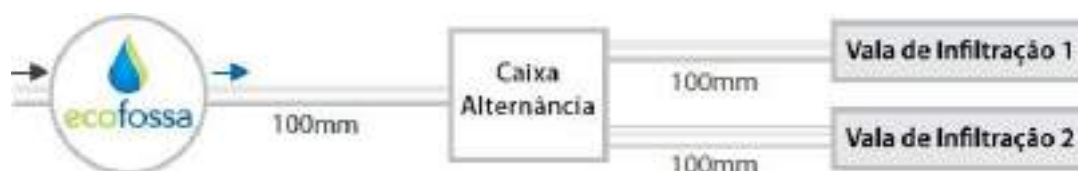
Figura 56: Sistema de Ecofossa,
