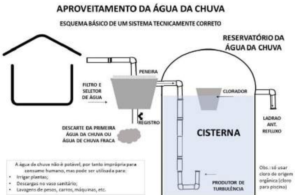
Figura 34: Sistema de Cisterna
