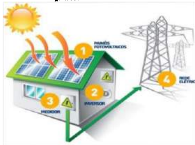
Figura 35: Sistema de Placa Voltaica
