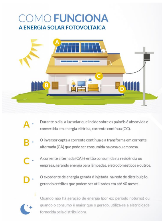
Figura 65: funcionamento do painel solar.
