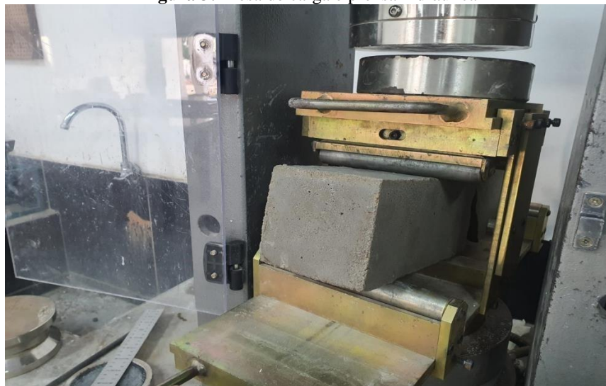
Figura 3: Mesa de carga e prensa hidráulica
