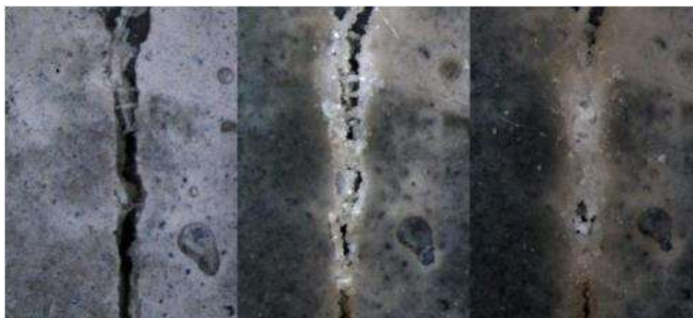
Figura 1: Concreto biológico em processo de autorregeneração do concreto
